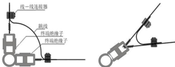
合金线之间的连接示意图（不锈钢+玻纤前端支撑杆）
