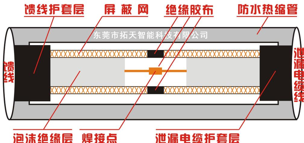
图 2 馈线和泄漏电缆线连接图
