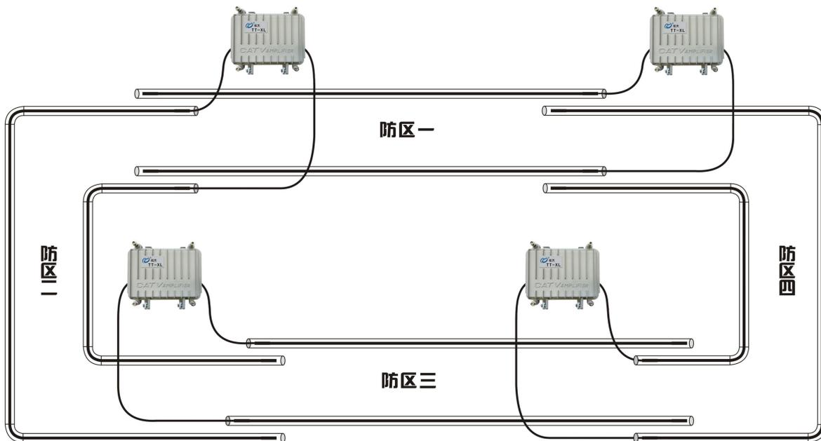
图 5 多机安装示意图
