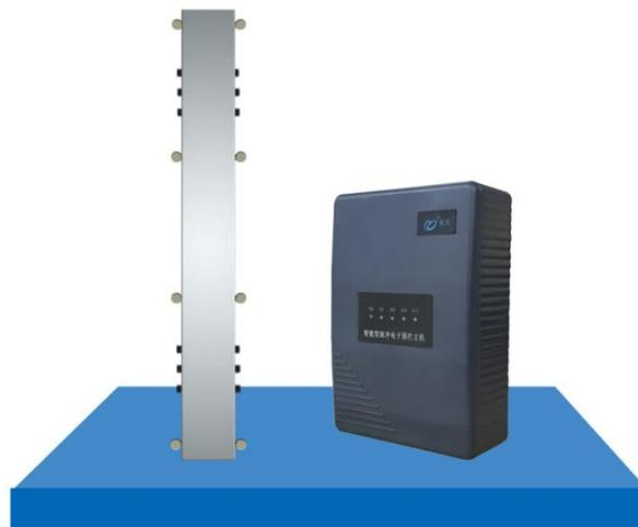
采取新的函数算数，确保因为环境温度的变化而造成张力值的变化。张紧值，松弛值会自动随着静态张力值的变化而变化，保持一定的报警参数，彻底改变了以往周界安防探测器环境适应性差、易误报的缺点。因此，拓天张力式智能电子围栏可以在风霜、雨雪、浓雾、沙尘、高温、低温等严酷环境下始终忠于职守，全天候稳定可靠的工作。当出现非法越墙（或越栏）时，在报警管理中心能立即收到报警信息，并发出声、光报警，同时现场能联动相关设备（如声光警号、摄像机等）。
